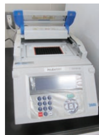
←PCR装置 遺伝子を増幅・分析する装置。 疾病の検査に役立つ。
