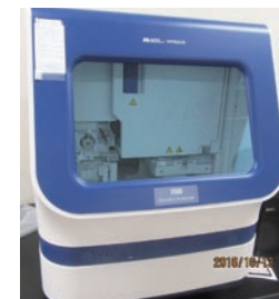
←DNAシーケンサー DNAの塩基配列を読み取る。 感染経路特定も可能になる。
